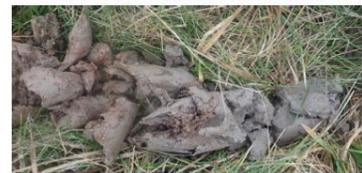
Illustration du sondage n°7 : Des traits rédoxiques sont visibles à partir de 55 cm de profondeur en s'intensifiant, puis laissent place à un horizon réductique. A partir de 100 cm, un horizon sableux sans marque d'hydromorphie est identifié. Ce profil n'est pas caractéristique de zone humide.
